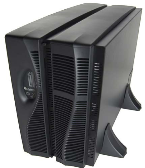
GXT2U als Tower- und Rack-konvertierbar mit 4500VA und 6000VA (3U)
